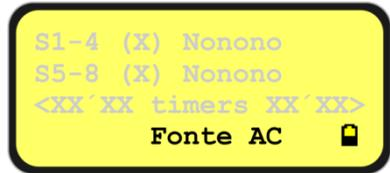
Quando a operação é garantida pela bateria, o EL-608 se desliga automaticamente se um comportamento ocioso for detectado.
