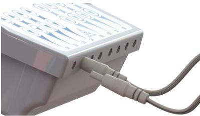
Os cabos de conexão aos eletrodos (Cabo Jacare mini - 2m - Safety Plug) devem ser introduzidos totalmente nos acessos aos canais de estimulação localizados na parte frontal do equipamento. Por tratar-se de conexão segura, é normal a sensação de aperto.
