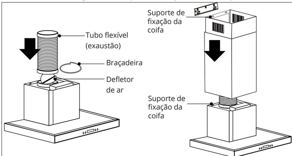
**NOTA:** As duas aberturas de ventilação estão posicionadas no duto/corpo na parte superior, com um diâmetro de 6mm. Deite o tubo de exaustão para a saída da parede. Fixe o tubo de exaustão com a braçadeira na saída da parede.
