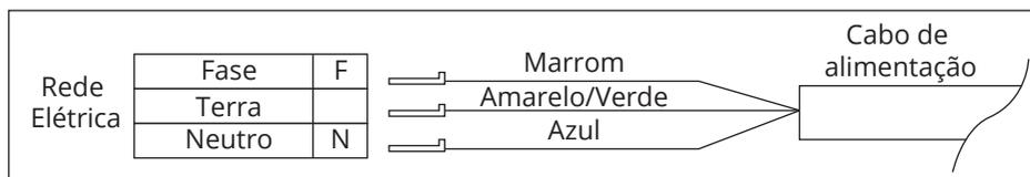
Certifique-se de que a temperatura do cabo da rede elétrica não ultrapasse 50 °C.
