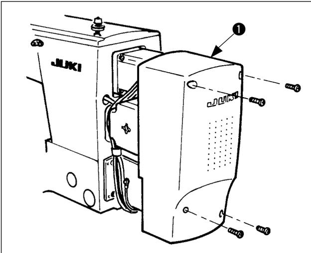
Instale la cubierta ❶ del motor en la unidad principal de la máquina de coser con los tornillos suministrados con la máquina como accesorios.
