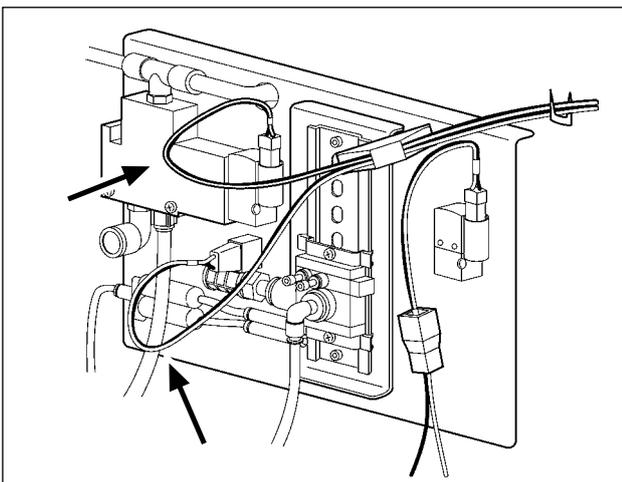
**Si algún cable está suelto, fije el cable sobre la mesa utilizando la grapadora que se suministra con la unidad.**
