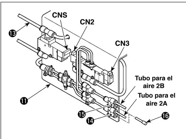
8) Instale los tubos de aire provenientes del cabezal de la máquina a la junta del cjto. A **11** de la placa de instalación de la válvula de solenoide, tal como se muestra en la figura. Instale en **14** y **15** los dos tapones de tope **16**, que se suministran como accesorios. Conecte a la válvula de solenoide los cables (CN2, CN3, CNS) provenientes de la caja de control.
