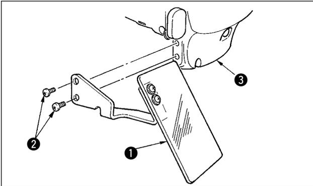
Use la cubierta protectora de los ojos ① después de colocarla con seguridad en la cubierta ③ de la placa frontal con los tornillos ②.
