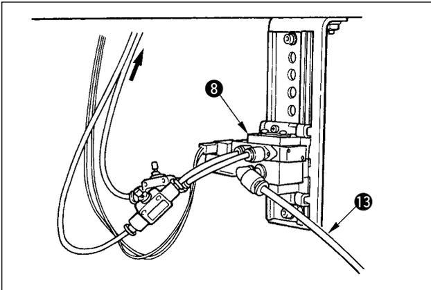
7) Conecte el tubo de aire **8** del cjto. A **11** de la placa de instalación de la válvula de solenoide al cjto. de válvula de solenoide **8**.
