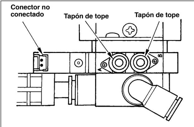
6) Instale en el cpto. de válvula de solenoide **8** los tapones de tope, que se suministran con la máquina como accesorios.
