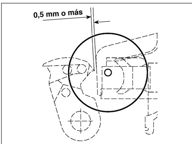
Después de la recuperación de la memoria del origen, pulse la tecla SET READY en el panel IP para verificar que exista una separación de 0,5 mm o más entre el extremo superior de la cuchilla móvil y el extremo superior del sujetahilo de la aguja. Si no se puede obtener la separación de 0,5 mm o más, ajuste la posición de la cuchilla móvil dentro de  $18,5 \pm 0,5$  mm para obtener la separación especificada.
