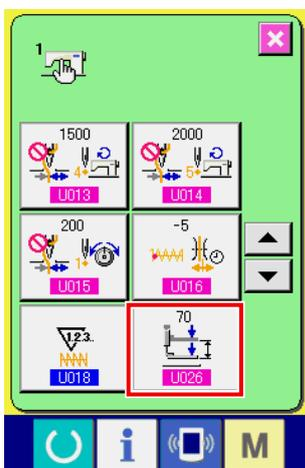
La posición de carrera de 2 pasos que se utiliza en el patrón del usuario puede fijarse con el interruptor de memoria **U026**.
