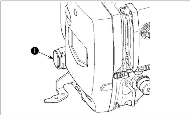
Cuando durante el cosido se presione el interruptor ❶ TEMPORARY STOP, se puede parar la máquina de coser. Ahora, la pantalla de error se visualiza para informar que se ha presionado el interruptor de parada.
