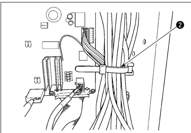
2) Fije el cable que se colocará en la CAJA DE ALIMENTACIÓN con una abrazadera para cable interno ❷.
