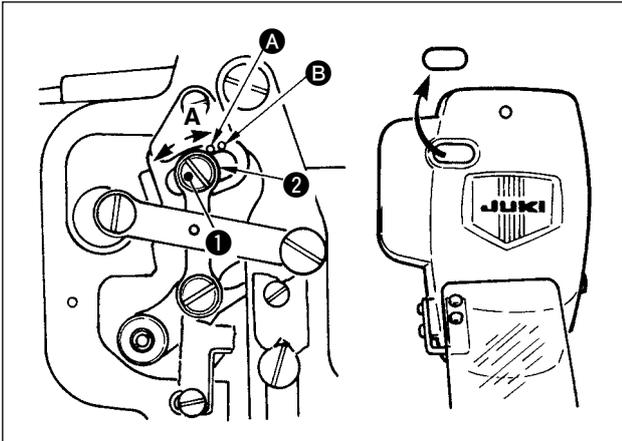
\* Conecte la corriente eléctrica una vez, y desconecte nuevamente la corriente eléctrica después de lograr que el prensatelas intermedio esté en estado bajado.
