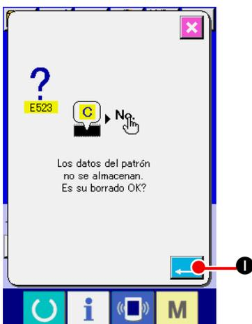
En el caso del display de cambios **H**, se visualiza la pantalla de confirmación del cambio cuando se cambia el patrón.
