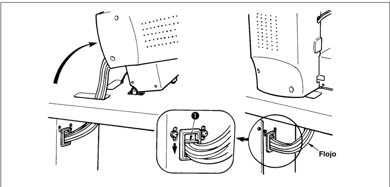
1) Fije los cables con la placa ❶ de fijación de cables en el estado en que los cables estén flojos hasta el punto que no se aplique excesiva fuerza a los cables aún cuando esté inclinado el cabezal de la máquina de coser como se muestra en la figura.
