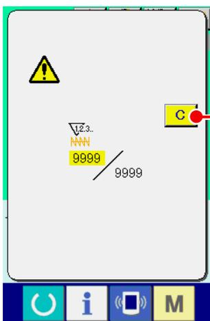
Quando durante el trabajo de cosido se llega a la condición de conteo ascendente, se visualiza el conteo ascendente y suena el zumbador. Pulse el botón **C** **A** CLEAR para reponer el contador y la pantalla retorna a la pantalla de cosido. Entonces el contador comienza a contar de nuevo.
