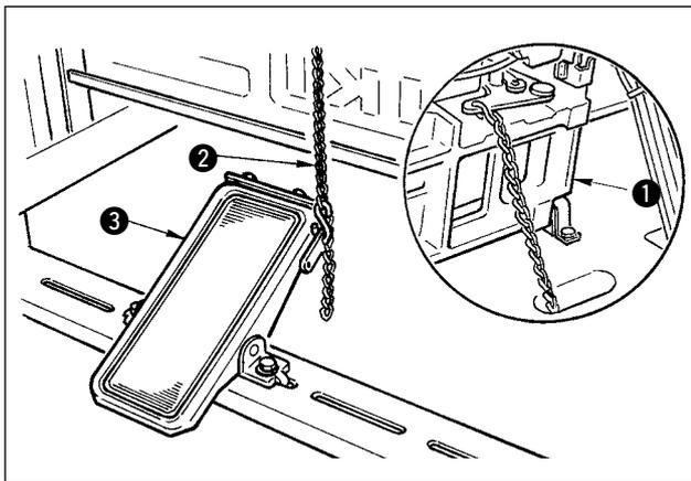
Conecte la máquina de coser ❶ y el pedal manual ❸ con la cadena ❷.
