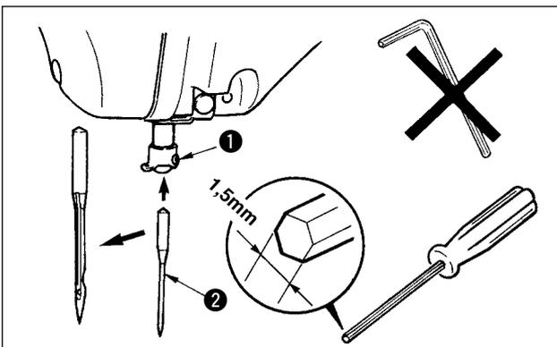
Aflove el tornillo ① y fije la aguja ② con la ranura larga mirando hacia usted. Seguidamente, inserte la aguja en el agujero en la barra de aguja, y apriete el tornillo ①.
