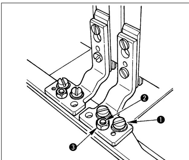
Si el bastidor de transporte se encuentra paralelo a la placa de agujas, es probable que disminuya la presión del lado frontal del bastidor de transporte. Por consiguiente, asegúrese de ajustar la inclinación del bastidor de transporte de modo que el lado frontal del mismo se encuentre ligeramente más bajo que su lado posterior.
