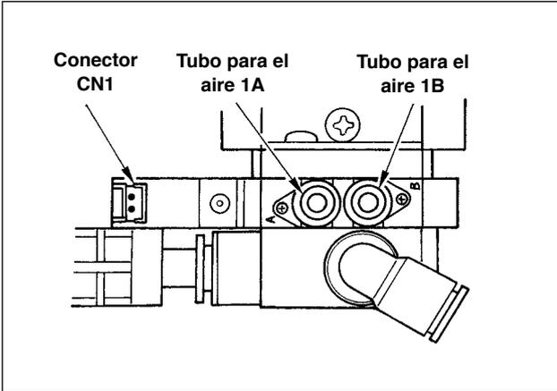
6) Instale los tubos para el aire que vienen desde el cabezal de la máquina y los cables que vienen desde la caja de control en la posición que se muestra en la figura. Ahora, ponga cuidado en el número y letra alfabética de los tubos para el aire y los cables. (Ajuste el alfabeto de los tubos para el aire y los cables. (Ajuste el alfabeto de los tubos para el aire y el alfabeto de la válvula de solenoide . Además, ajuste las cifras a las cifras de la etiqueta del conector.)
