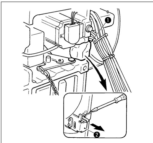
Quite la cinta ① sujetador de la selección de la palanca del interruptor ② de seguridad.
