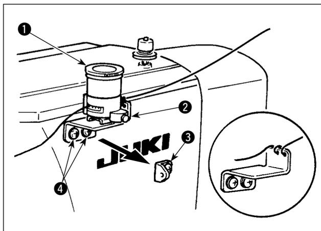
Retire el guía tomahilos № 1 ❸ y asegure la base ❷ del tanque de aceite de silicona.
