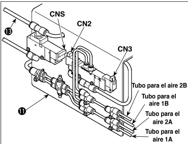
8) Instale los tubos de aire provenientes del cabezal de la máquina a la junta del cpto. A **11** de la placa de instalación de la válvula de solenoide, tal como se muestra en la figura. Conecte a la válvula de solenoide los cables (CN2, CN3, CNS) provenientes de la caja de control.
