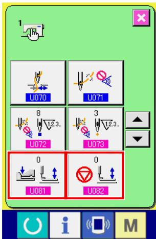
La función de carrera de 2 pasos se puede usar modificando la configuración de los interruptores de memoria **U081** y **U082**.
