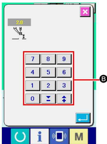
Presione el botón INTERMEDIATE PRESSER SETTING **A** y ajuste las TEN (diez) teclas **B** de modo que la separación entre el extremo inferior del prensatela intermedio y la tela sea 0,5 mm (Se usa grosor de hilo).
