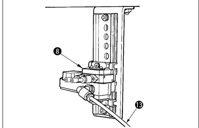
7) Conecte el tubo de aire **13** del cpto. A **11** de la placa de instalación de la válvula de solenoide al cpto. de válvula de solenoide **8**.
