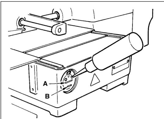
Compruebe que el lugar entre la línea inferior B y la línea superior A está lleno de aceite. Cuando el aceite sea insuficiente, el relleno de aceite se hace usando la aceitera que se suministra con la máquina de coser como accesorio.
