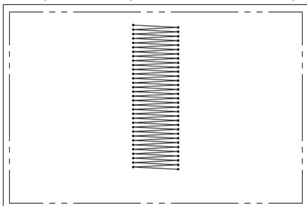
La película de grasa en el engranaje de transporte es probable que se agote cuando se utilice la máquina para coser una forma de cosido con costura continua de transporte inverso, tal como se muestra en la figura de la izquierda. Para mantener la película de grasa en el engranaje de transporte, ejecute los dos siguientes pasos del procedimiento.
