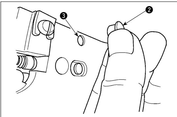
Cuando el hilo queda atrapado en el extremo superior **1** del sujetador de hilo, el sujetador de hilo no funciona bien y se originará problemas al inicio del cosido. Desmonte y limpie periódicamente la placa de agujas porque es fácil que se acumule polvo y desperdicios de hilo en los lugares marcados con un círculo.
