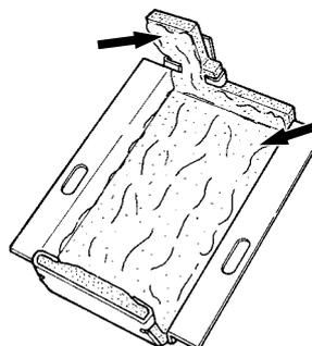
■ Para agregar grasa a la sección de bujes superior e inferior de la barra de agujas, sección de bloque de deslizamiento, y sección de buje inferior de la barra del prensatelas intermedio
