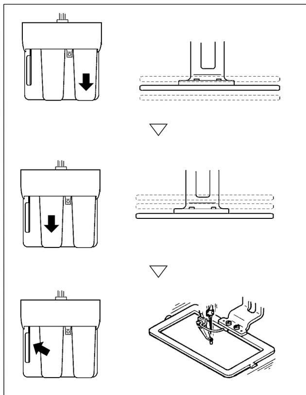
① Cuando se presiona el pedal derecho, el prensatelas se detiene en la posición intermedia.
