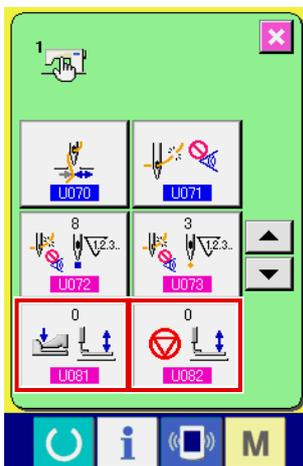
La función de carrera de 2 pasos puede usarse modificando la configuración de los interruptores de memoria **U081** y **U082**.
