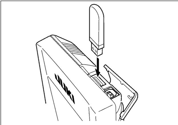
Deslice la cubierta superior e inserte el dispositivo USB en el puerto USB. Luego, copie los datos a usar desde el dispositivo USB al cuerpo principal. Al término del copiado de datos, retire el dispositivo USB.
