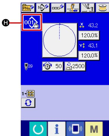
Cuando se ejecuta la proporción de aumento/reducción de X/Y, comando de tensión del hilo, o prensatela intermedio, o valor de adición/disminución de prensatela intermedio de patrón de usuarios, o se ejecuta el patrón de tarjeta de memoria, la sección de clase de patrón cambia de visualización **H**.
