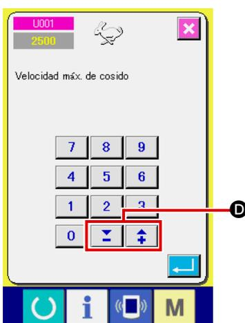
El No. de color rosado tal como el **U001** se introduce en los ítems de dato para cambiar numerales y el valor fijado se puede cambiar con los botones + / - **D** introducidos en los ítems de datos para seleccionar pictógrafos y se pueden seleccionar los pictógrafos visualizados en la pantalla de cambio.
