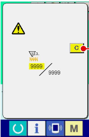
Quando durante el trabajo de cosido se llega a la condición de conteo ascendente, se visualiza el conteo ascendente y suena el zumbador. Pulse el botón **C** **A** CLEAR para reponer el contador y la pantalla retorna a la pantalla de cosido. Entonces el contador comienza a contar de nuevo.
