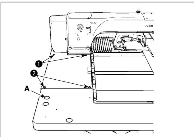
2) Retire los pernos de fijación 3 de la mesa que se encuentran instalados en dos puntos del pedestal de la mesa.
