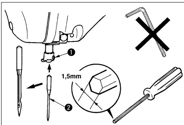
Afloje el tornillo **1** y fije la aguja **2** con la ranura larga mirando hacia usted. Seguidamente, inserte la aguja en el agujero en la barra de aguja, y apriete el tornillo **1**.
