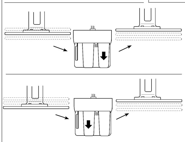
④ Cuando se presiona el pedal derecho nuevamente en el estado en que el prensatelas está en la posición intermedia, el prensatelas se eleva a su punto muerto superior.
