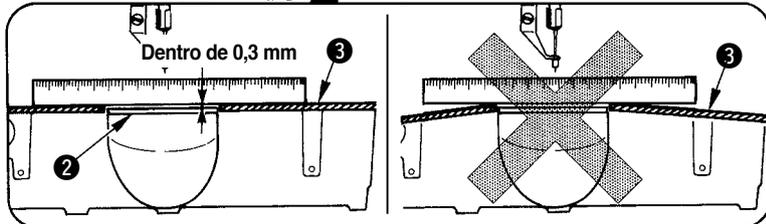
1. Fije la cubierta auxiliar de la placa de agujas ③ de modo que quede más alta que la placa de agujas ② (dentro de 0,3 mm). Cuando está más bajo que la placa de agujas ②, se romperá la aguja o semejante debido a un transporte defectuoso.
