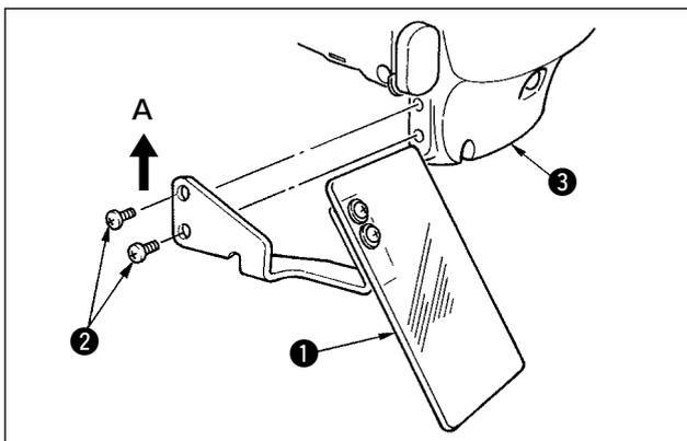
Use la cubierta protectora de los ojos ① después de colocarla con seguridad en la cubierta ③ de la placa frontal con los tornillos ②.
