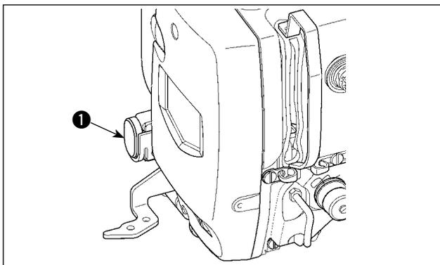
Cuando durante el cosido se presione el interruptor ① TEMPORARY STOP, se puede parar la máquina de coser. Ahora, la pantalla de error se visualiza para informar que se ha presionado el interruptor de parada.
