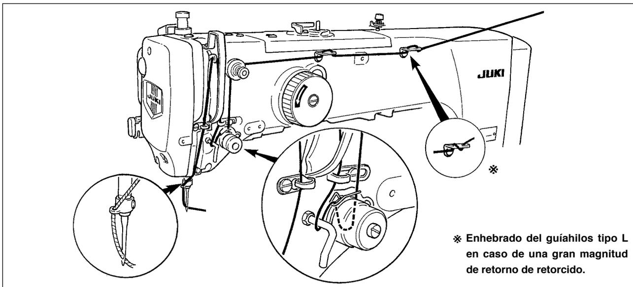
\* Enhebrado del guíahilos tipo L en caso de una gran magnitud de retorno de retorcido.
