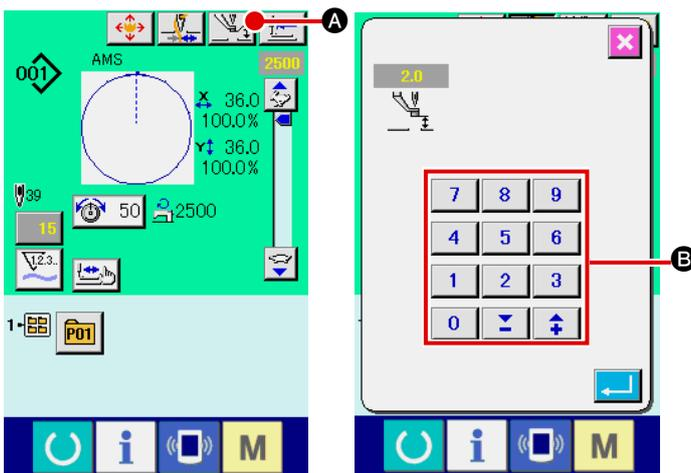
Presione el botón INTERMEDIATE PRESSER SETTING ① A y ajuste las TEN (diez) teclas ② B de modo que la separación entre el extremo inferior del prensatela intermedio y la tela sea 0,5 mm (Se usa grosor de hilo).
