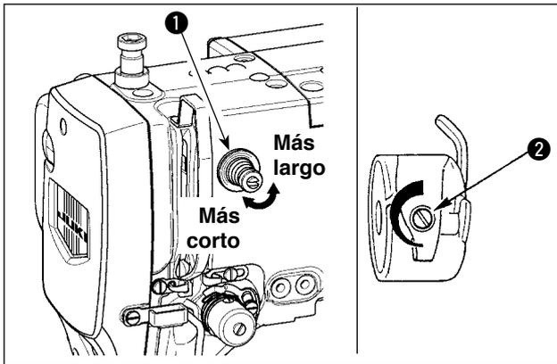
Si se gira hacia la derecha el controlador de tensión de hilo N° 1 ①, la longitud del hilo remanente en la aguja después de cortado el hilo será más corta. Si se gira hacia la izquierda, la longitud será más larga.
