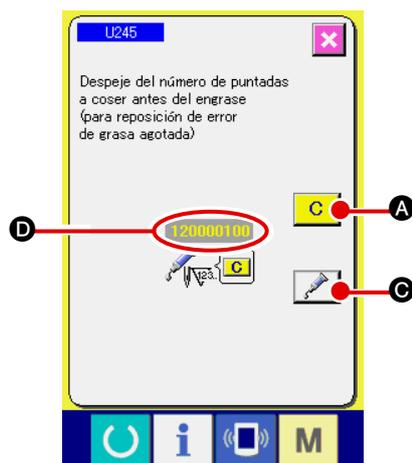
Quando se pulsa la tecla RESET **B** sin haber rellenado grasa en los lugares especificados, se visualizará el código de error “E221 Error de rellenado de grasa” cada vez que se enciende (“ON”) la máquina de coser a partir de entonces y la máquina de coser no funcionará. Por lo tanto, tenga cuidado.
