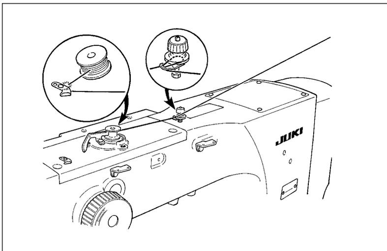
Enhebre el bobinador y bobine el hilo de bobina en la bobina como se ilustra en la figura.
