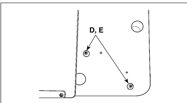
9) Fije, usando los tornillos de rosca para madera (accesorio E), los retenes (accesorio D) del panel de operación en las ubicaciones perforadas en el lado anterior de la mesa derecha.
