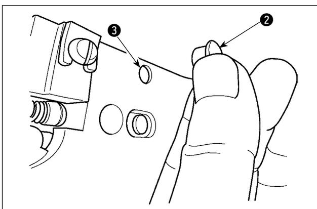
Cuando el hilo queda atrapado en el extremo superior ① del sujetador de hilo, el sujetador de hilo no funciona bien y se originará problemas al inicio del cosido. Desmonte y limpie periódicamente la placa de agujas porque es fácil que se acumule polvo y desperdicios de hilo en los lugares marcados con un círculo.
