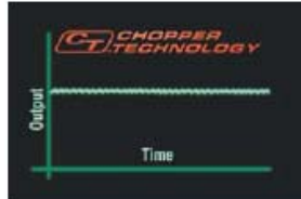
La tecnología Chopper le proporciona una respuesta extremadamente rápida con una salida mas estable.
