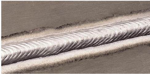
La frecuencia pulsante es ajustable. Cambiar la modulación de la frecuencia (o control del arco) de la forma de onda cambia el espacio del rizado. Es posible lograr velocidades de recorrido más rápidas utilizando valores más altos de modulación de frecuencia. (Vea la Figura B.8 y B.9p)
