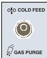
Para activar la Alimentación en Frío, mantenga el interruptor en la posición **HACIA DELANTE (FORWARD)**. El mecanismo de alimentación alimentará al electrodo pero ni la fuente de poder ni el solenoide de gas estarán energizados. Ajuste la velocidad de la alimentación en frío girando la perilla WFS. Alimentar o “desplazar” el electrodo en frío es útil para pasar el electrodo a través de la pistola.
