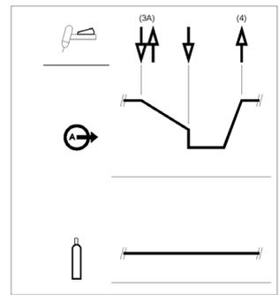
Como se puede ver aquí, después de apretar y soltar rápidamente otra vez el gatillo de la antorcha TIG en el paso 3A es posible pulsar y soltar rápidamente el gatillo de la antorcha TIG una vez más para finalizar el tiempo de la pendiente descendente y dejar de soldar.
