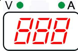
Si el LED "A" está encendido, el medidor muestra la corriente de soldadura preestablecida (en A) antes de soldar y la corriente real durante la soldadura. Si el LED «V» está encendido, el medidor muestra la tensión (en V) en los cables de soldadura. Para cambiar la visualización entre corriente y tensión, realice las siguientes acciones:
