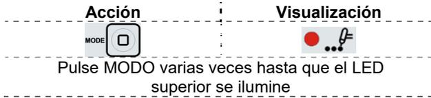
Este modo de soldadura se utiliza principalmente para realizar soldaduras provisionales o sobre materiales finos. El arco arranca con alta frecuencia y la corriente de soldadura se establece inmediatamente sin pendientes ascendente y descendente. El tiempo de soldadura se puede controlar mediante el gatillo o ajustando el tiempo de punto.
