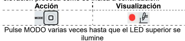
Cuando el botón de modo está en la posición Lift TIG, las funciones de soldadura por electrodo convencional se desactivan y la máquina está preparada para la soldadura Lift TIG. Lift TIG es un método para iniciar una soldadura TIG; primero, se apoya el electrodo de la antorcha TIG contra la pieza para crear un cortocircuito con una corriente de baja magnitud. Luego, se separa al electrodo de la pieza para crear el arco TIG.
