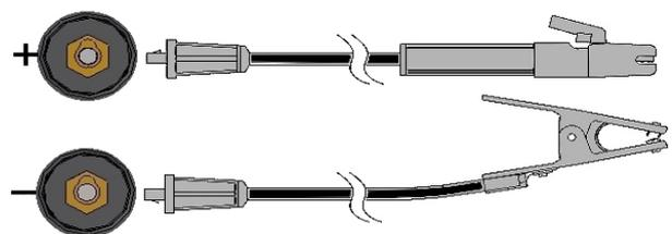
Conecte el cable de pinza al conector de salida (+) y el cable de masa al conector de salida (-). Inserte el enchufe con la guía alineada con la ranura y gire aproximadamente 1/4 de vuelta en el sentido de las agujas del reloj. No apriete en exceso.
