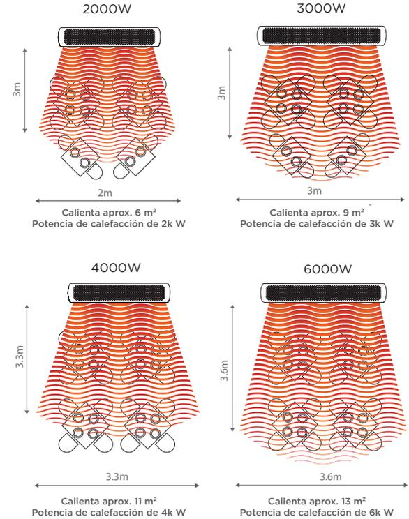
\*El área de calefacción depende de la temperatura ambiente y del viento. Las condiciones óptimas se producen cuando la temperatura es de aprox. 15.5 °C en un entorno cubierto con viento suave. La disposición de la tabla es meramente indicativa.
