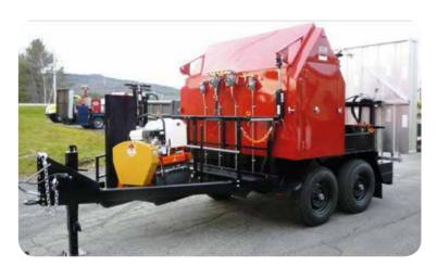
De 2 y 4 toneladas de capacidad de asfalto tiene un Calentador Infrarrojo de 4.5 Mts2. Sobre un Chasis para enganchar en un camión o una Pick UP.
