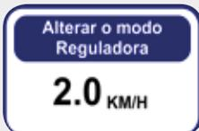
Nessa opção, você pode determinar a velocidade mínima que a Reguladora irá trabalhar automaticamente. E esse valor só será alterado quando for adquirido o equipamento e licença “GPS+Vazão” ou “GPS + FULL”.
